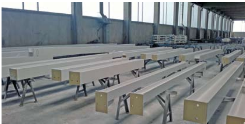
R30-plattinierte Stahlbauteile – nur ein Spritzgang auf gestrahltem Stahl
