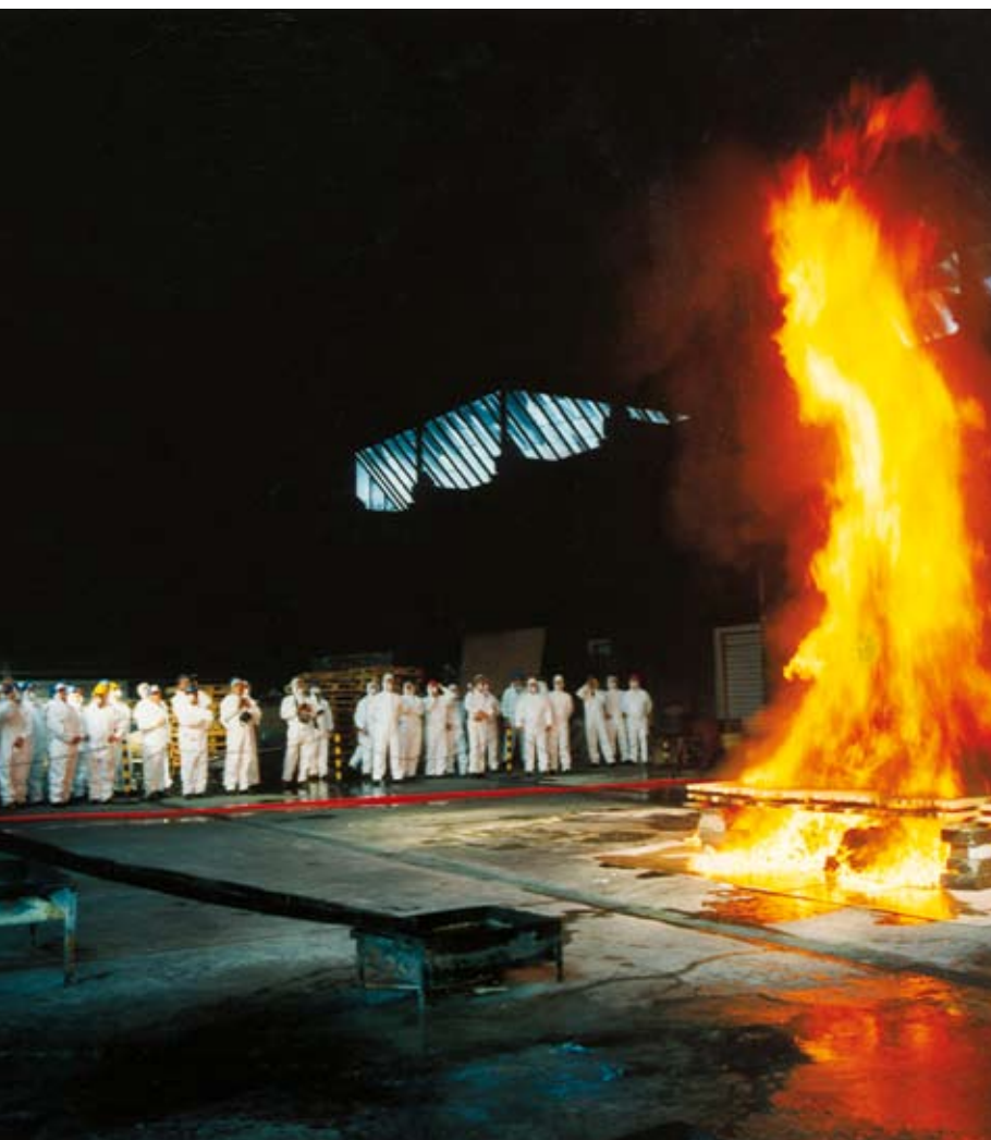
Großbrandversuche von Colt im Testzentrum in Gent. 10000 m 3 verqualmen in wenigen Minuten
